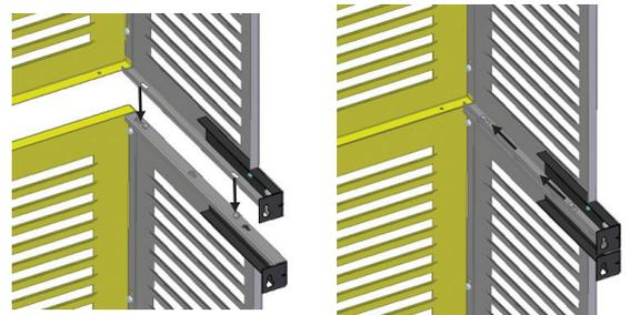
**4** Um 2 Gitter übereinander zu befestigen, die Oberseite nicht befestigen zwischen die 2 Gitter, dann die 2 Gitter clipsen und mit Muttern sichern
