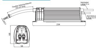
Sie kann in beliebiger Anordnung in einem Abstand von bis zu 7 m zur Klimaanlage eingebaut werden.
