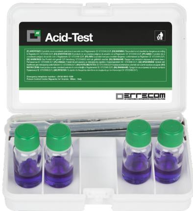
ACID-TEST ist ein unverzichtbares Produkt, um die Präsenz bzw. die Bildung von Säure im Inneren einer Kälte- und Klimaanlage festzustellen. Der Einsatz von ACID-TEST ist ein sehr wichtiger Schritt bei der regelmäßigen Wartung, denn es ist eine extrem schnelle und präzise Methode zur Lokalisierung von eventuell vorhandener Säure im Schmiermittel.
