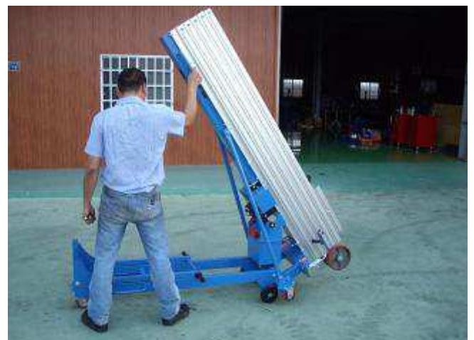
Das Fahrgestell kann geklappt werden
