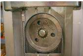
Laufrollen und Kabelschutz aus Stahl
