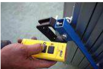
Funkfersteuerung mit Not-Aus
