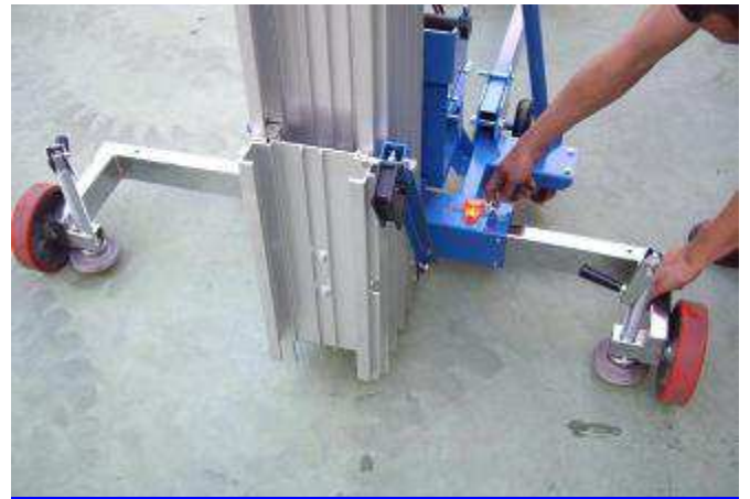
Einstellbare Seitliche Ausleger mit Libellenwaage und Stützfüße mit Spindel für unebenen Boden
