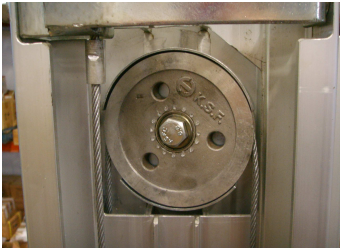
Lauffrollen und Kabelschutz aus Stahl
