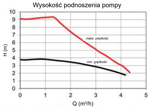
Dostępne zewnętrzne ciśnienie statyczne VS Natężenie przepływu
